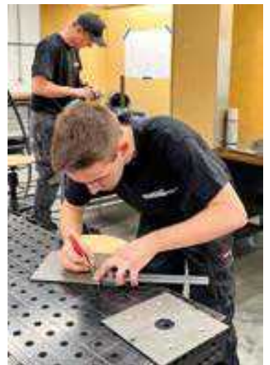
Übertragen der Masse aus den Plänen aufs Metall.
